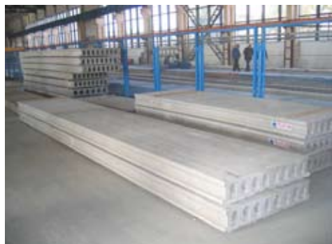
Фото 5. Плиты пустотного настила.
