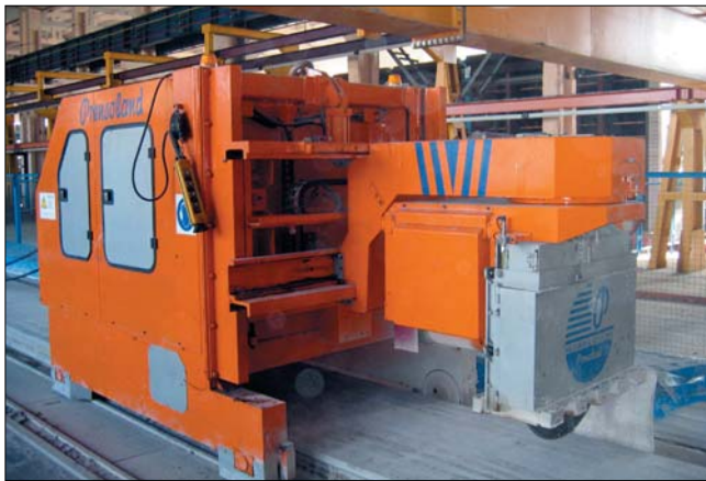
Рис. 4. Участок линии «Тэнсиланд» – машина для резки под любым углом затвердевших плит
