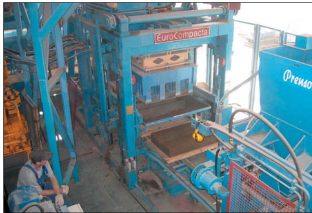
Рис. 5. Высокопроизводительная автоматическая линия «Еврокомпакта» для производства стеновых и перегородочных блоков
