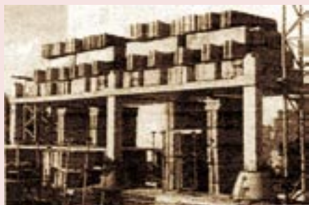
Фото 1. Испытания на длительное действие нагрузки плиты в условиях продольного распора, испытание фрагмента каркаса до разрушения (коэффициент безопасности по ГОСТу c=1,98 ).
